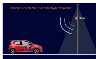
Principe de détection par radars hyperfréquence des véhicules ©Ville de Lyon
